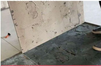
现象一:瓷砖界面层空鼓脱落
